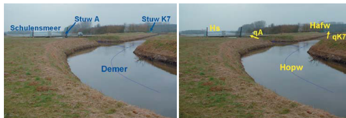
Figuur 4.5: Foto's van de Demer met het Schulensmeer waarop enkele variabelen uit het grote en het kleine model aangeduid zijn. De figuur stelt een visuele vertaling voor van de realiteit naar enkele modelelementen zoals de kleppen en waterhoogten. Bron: [12]
