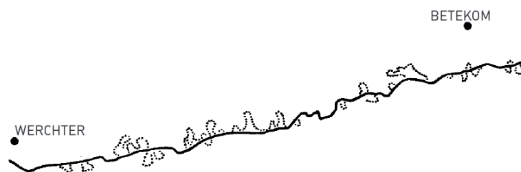
Figuur 2.3: De evolutie van de Demer: rechtekking en afsnijding van meanders. Bron: [18]
