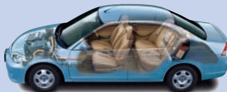
Superzuinige hybride auto met pm-motor/generator
